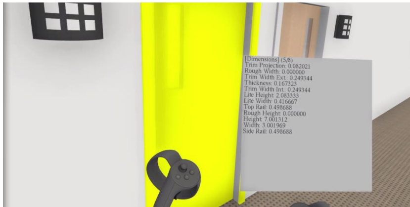
Figur 13: Val av objekt och visning av dess egenskaper (PropertySets).
