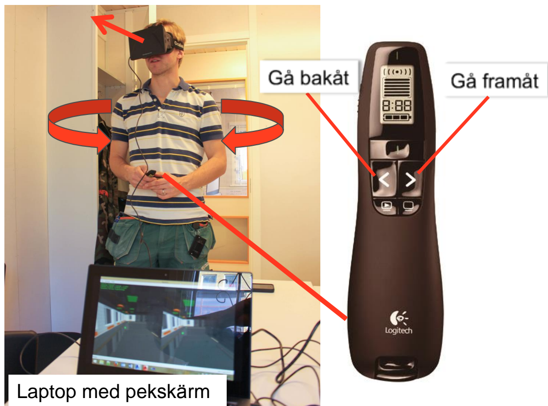
Figur 1. Med hjälp av VR-glasögon kan arbetsledare och yrkesarbetare enkelt navigera omkring i BIM-modellen i skala 1:1 för att få bättre förståelsen av arbetsmomenten och därigenom få effektivare planering och utförande av arbetsmomentet.
