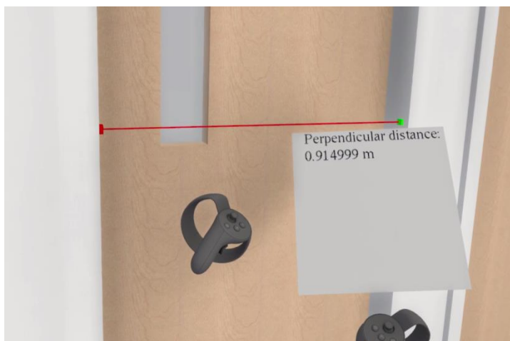
Figur 12: Användning av det vinkelräta mätverktyget.
