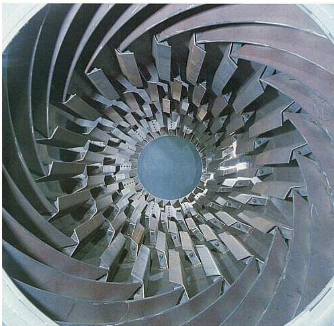
Figur 4. Insida av torktrumma [1].
