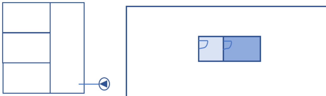
Figur 14: Typsektion och typplan för trycksättning utan krav på flöde över öppen dörr.
