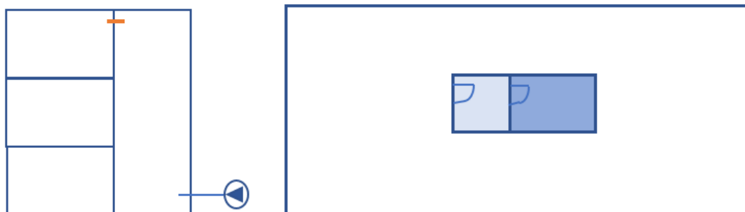
Figur 15: Typsektion och typplan för trycksättning med fläkt styrd av tryckgivare. Tryckgivarens placering är markerad med rött streck.
