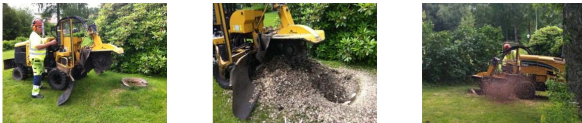
Figur 2-3: 120 hk stubbfräsningsmaskin som fräser ner en normalstorstubbe på 2 min.
