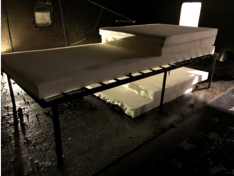
Figur 5. Ett exempel på brandbelastning i ett försök med verklighetsbaserad brand.
