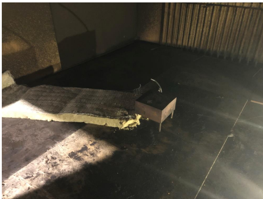
Figur 6. Gasolbrännaren som användes i försöken med bränder enligt BBRAD. Gasoltillförseln skyddas i bilden med en stenullsmatta.
