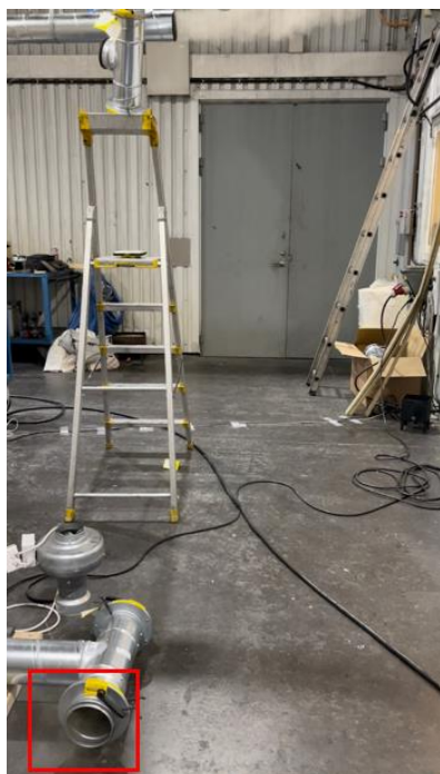
Figur 43. Bild på när brandgasspridning sker genom tilluften i VB1. Notera även brandgasflödet ur frånluften högst upp i bilden.
