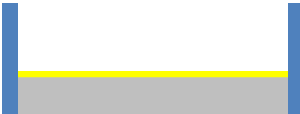
Figur 1. Principiell uppbyggnad av en golvkonstruktion där en golvbeläggning appliceras direkt på en betongplatta (eventuellt kompletterat med en avjämningsmassa). Eventuellt kan konstruktionen kompletteras med en stegljudsisolering (mellan betong och golvbeläggning).
