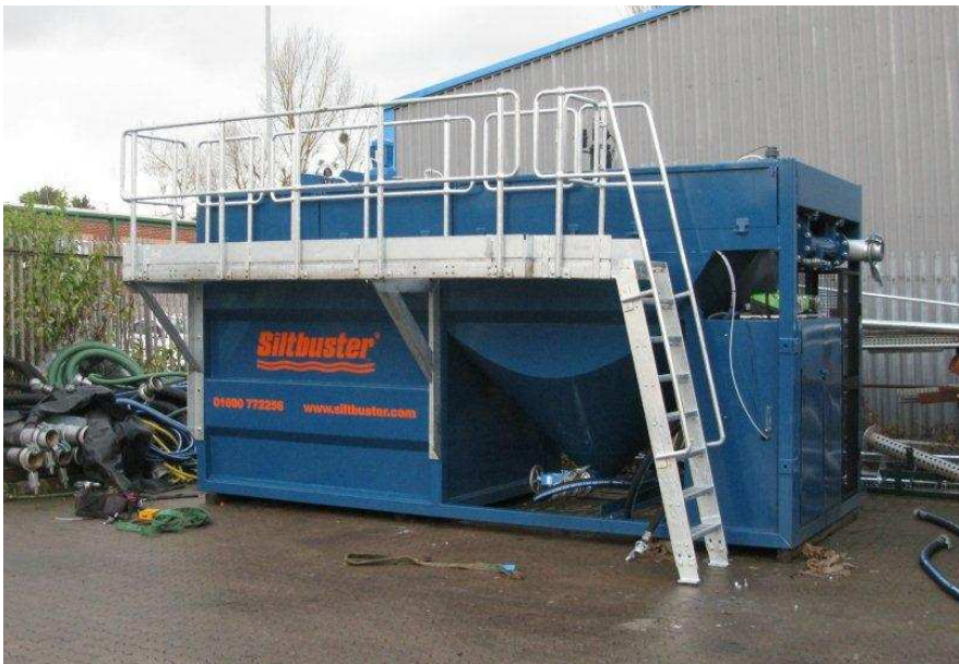
Figur 5.6. Mobil anläggning för fällning/flockning och sedimentering
