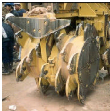
Figur 2.7 Exempel på maskinutrustning som används för tillverkning av slitsmurar. Från Bauer (2006).
