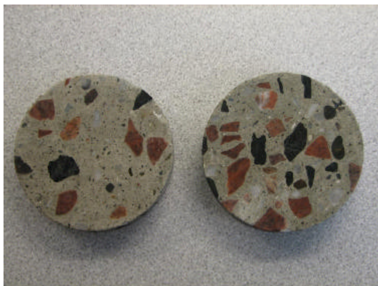
Figur 6.27 Tvärsnitt på de provkroppar med lägst respektive högst m (4 A-M A respektive 3 P-M D). En tydlig skillnad i cementpastainnehåll i provkropparna framgår.
