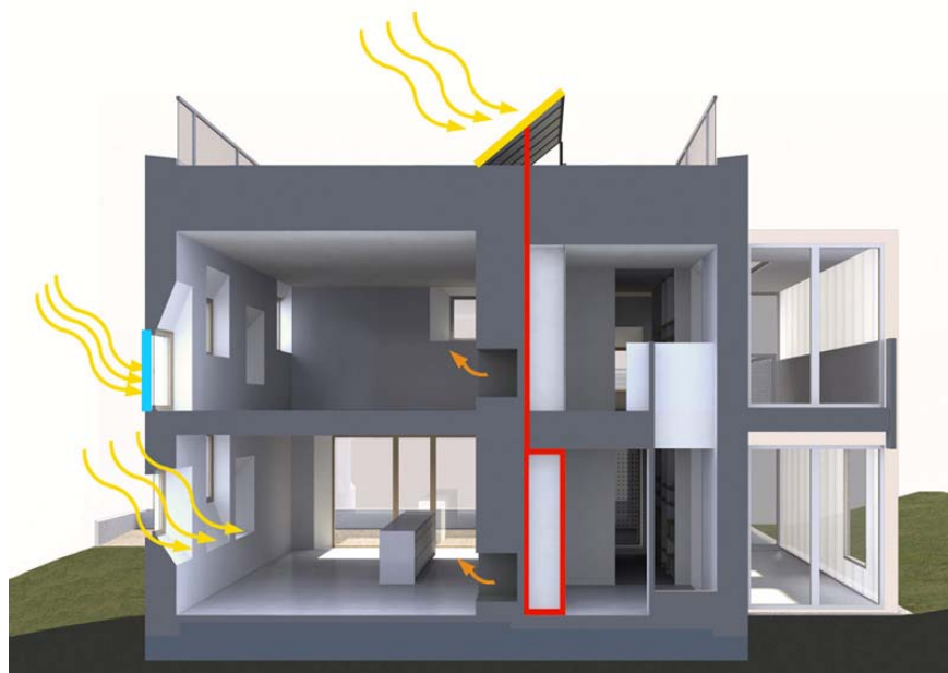
Värmesystemet. Solfångare på taket kopplade till ackumulatortank med uppvärmning av tappvarmvatten. Reglering av solinstrålning med rörlig utvändigt solavskärmning vid fönster
