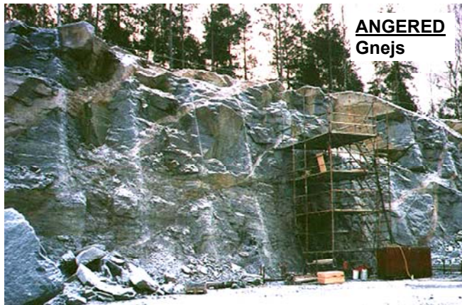
Figur 3, i den vänstra bilden ses Angered's bergtäkt och den byggnadsställning som bergkärnorna borrades från. I den högra bilden ses områden för försöken i Billingsryd.
