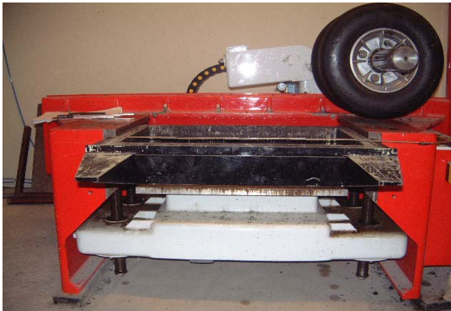
Bild 1 ”Plate compactor ” utrustning för packning av asfaltplattor.
