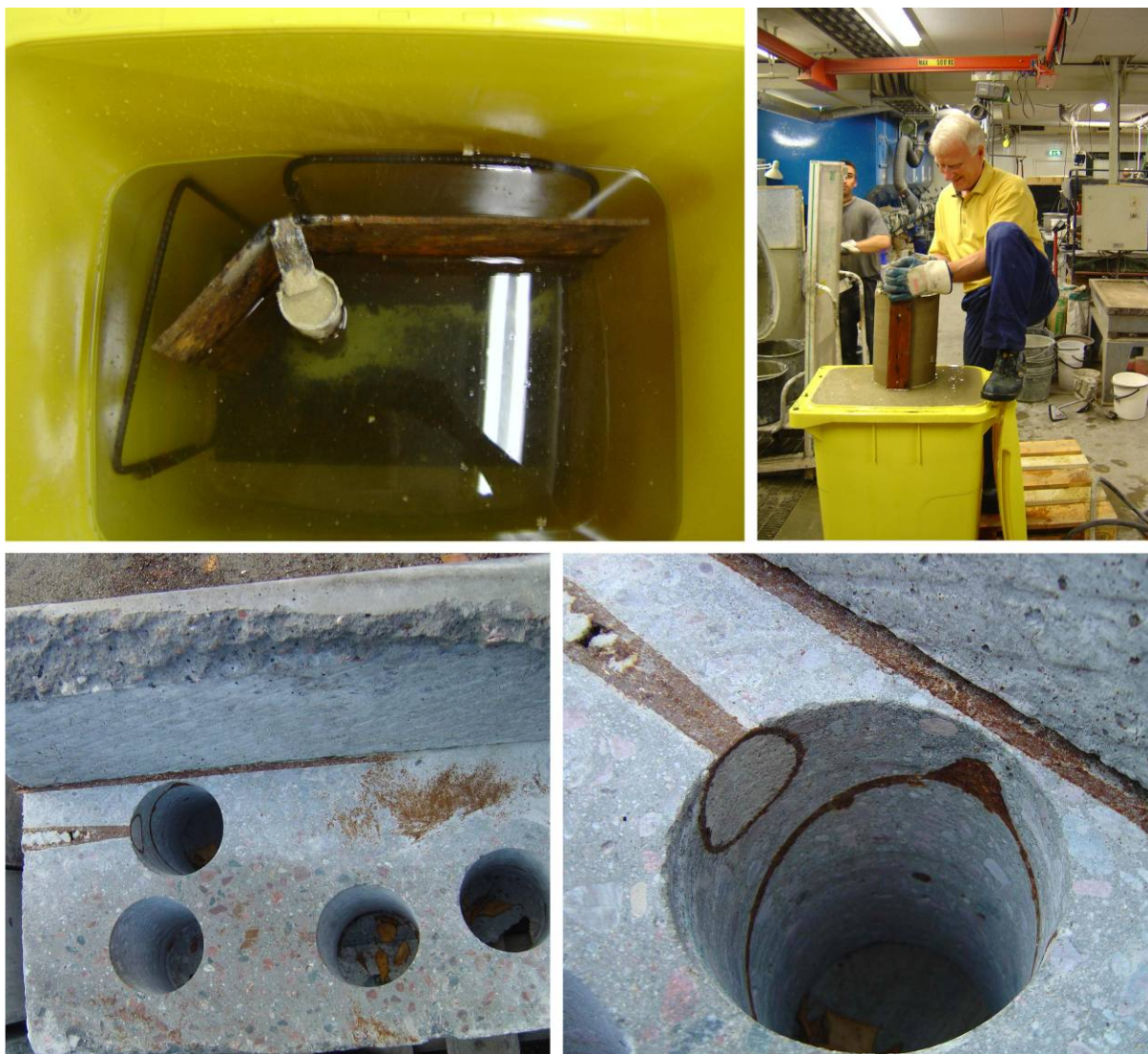
Figur 6: Gjutning i vattenfyllt plastkärl med förenklat ingjutningsgods, gjutning genom ett rör, borrning av prover och omslutning av ståldetaljer.
