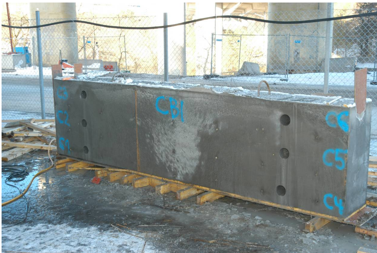
Figur 11: Avformad vägg med borrhärnor tagna på ”pumpsidan” (vänster) och ”flytsidan” (höger) i olika höjd.
