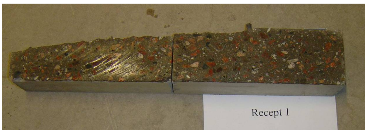
Figur 5: Sågad yta efter gjutning i en vattenfylld L-låda. De grova ballastkornen är väl fördelade i längd- och höjddled, detta indikerar god stabilitet i betongen.
