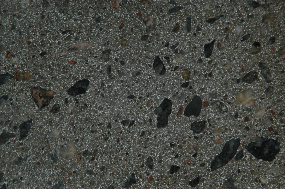
Figur 23: Planslip av cylinder 7, impregnerad med vit epoxi, för bestämning av lufthalt på hårdnad betong, hög andel fina luftporer med liten avståndsfaktor.
