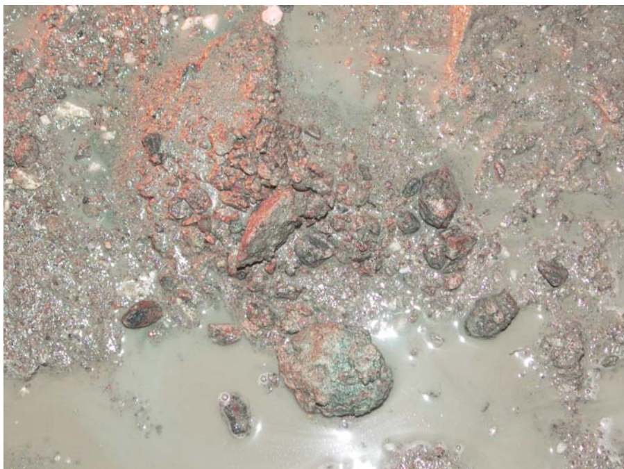
Bild på sönderfallen utborrad provkropp och kall spolärvätska (etylalkohol) på tunnelgolvet.
