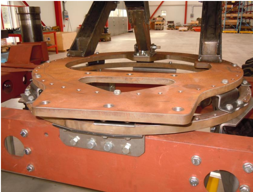
Figur 5 Fäste kran och hytt
