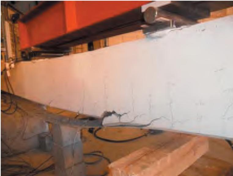
Figure E.1.2 Failure mode (Beam B2-EE1-S).
