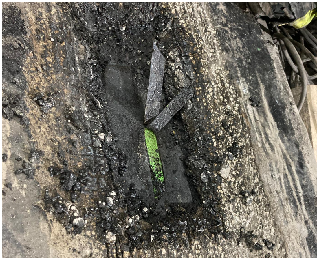
Figur 4 Vid manuellt rivprov lossnar mattan med lätthet på liten platta som legat tre år utomhus och som är primerförseglad med MMA (grön)
