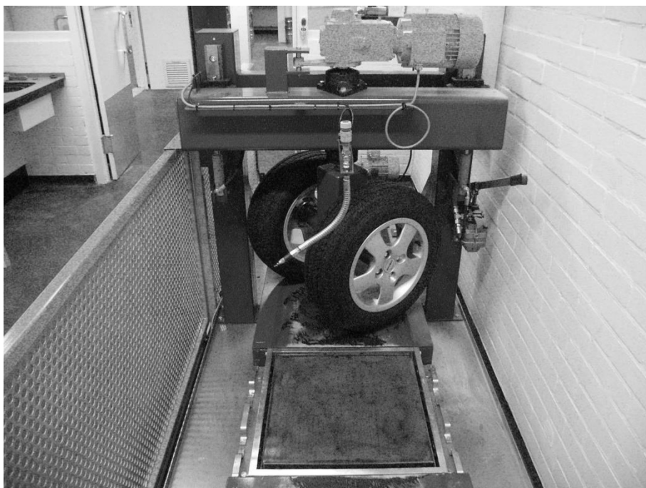
Figur 17 Exempel på utrustning för bestämning av slitstyrka
