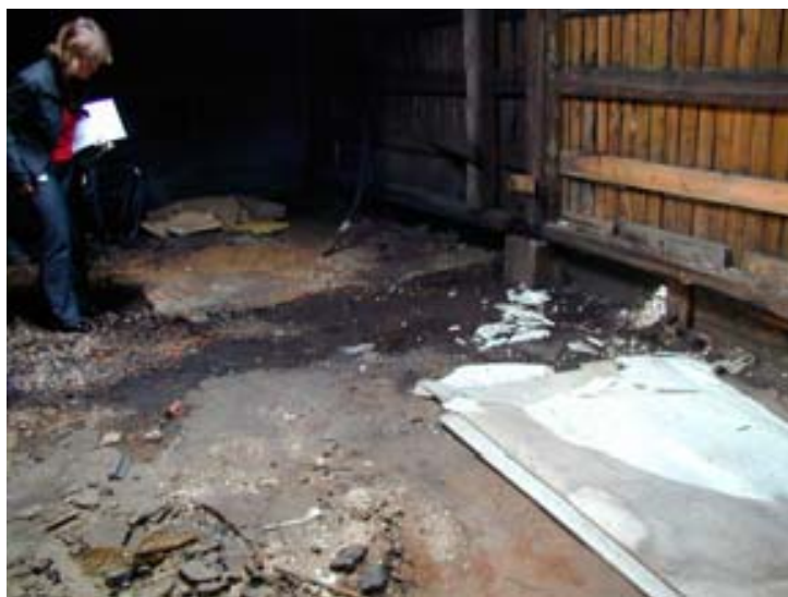
Bild 14: Vid platsbesöket fotograferas fastigheten och anteckningar görs på ritningar om var synliga föroreningar finns, var olika verksamheter har bedrivits samt spridningsrisker.
