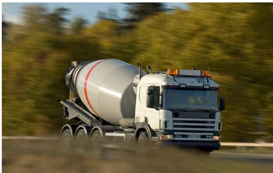
Figur 18. Redan någon timme efter blandning börjar betongens tillstyvna och därmed svårare att hantera vid gjutning. Fabriksbetong är därför ett lokalt producerat byggmaterial.
