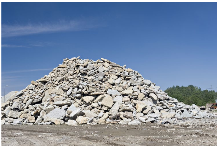
Figur 30. Betong från uttjänta byggnader kan återvinnas till hundra procent genom användning som fyllnadsmaterial på plats eller i annat projekt eller som ballastmaterial i ny betong.
