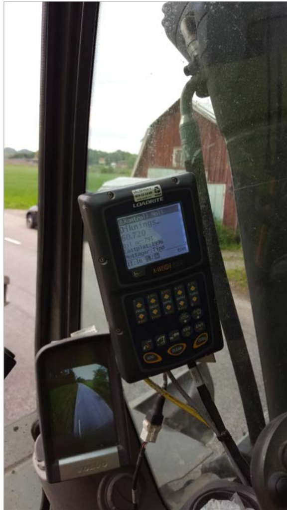
BILD 4, Display i maskinhytt som visar att vägning blivit korrekt samt senaste skopvikt samt total skopvikt
