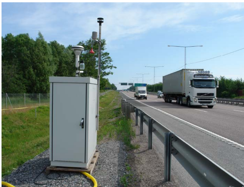
Figur 4. Den fast mätstationen för mätningar av PM10- och NOx-halter samt meteorologi intill provbeläggningen i Hallunda (mätplats A i figur 3).
