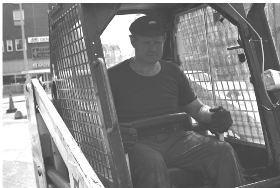
Bild 28. Förarmiljön är inte alltid den bästa på små maskiner. En längre tids arbete på en trång förarplats kan vara ganska påfrestande.
