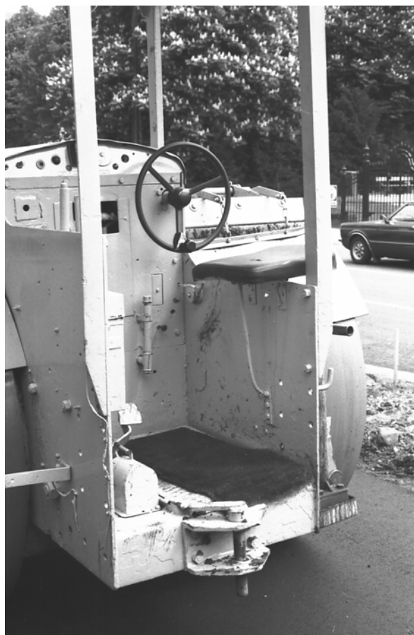
Bild 23. Förarmiljön på de gamla slätvältarna är omodern. Som pilotobjekt borde man modernisera några exemplar: bredda förarplatsen, modernisera reglagen och ordna alternativa förarplaceringar så att man kan stå eller sitta i båda färdriktningarna.
