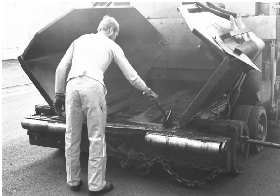
Bild 12. Det är svårt att ersätta diesel som rengöringsmedel i asfalthanteringen. Dieselångor, stänk och spillage är problem som måste lösas.
