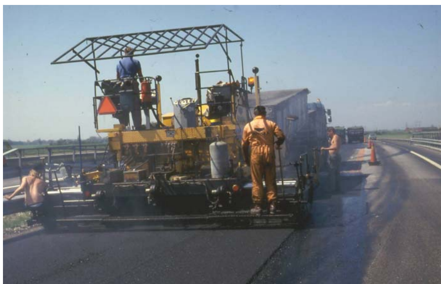
Bild 18. Ett tak över läggarer kan se ut på många sätt. På en bred ramkonstruktion kan skyddet placeras där det behövs, antingen enbart över föraren eller över hela maskinen vid uppställning.
