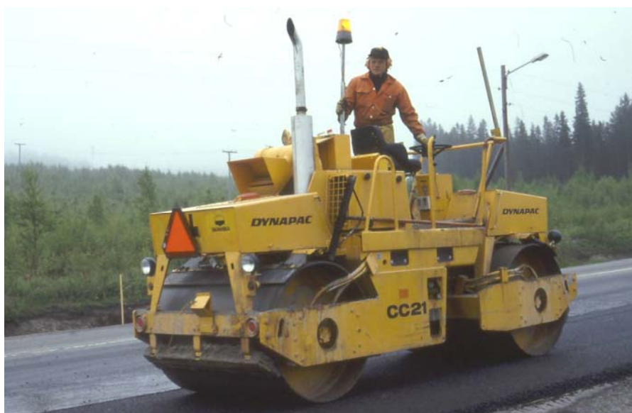
Bild 21. De vältförare som har möjlighet att stå föredrar det. Kroppen kan på det sättet placeras rakt i färdriktningen. Emellanåt kan han sätta sig ned. Varierad arbetsställning är alla maskinförare i behov av.
