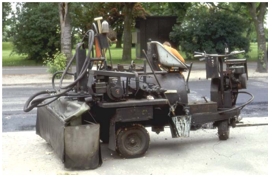
Bild 14. Det inträffar att klistermopeder välter i oförsiktiga manövrar. En skyddsståg skulle hindra att föraren kom i kläm.
