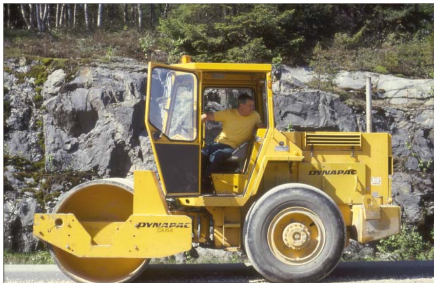
Bild 20. Många vältförare på vägbeläggningsarbeten tvingas inta en obekväm körställning under nästan halva arbetstiden. Det är oacceptabelt ur miljö- och säkerhetssynpunkt.
