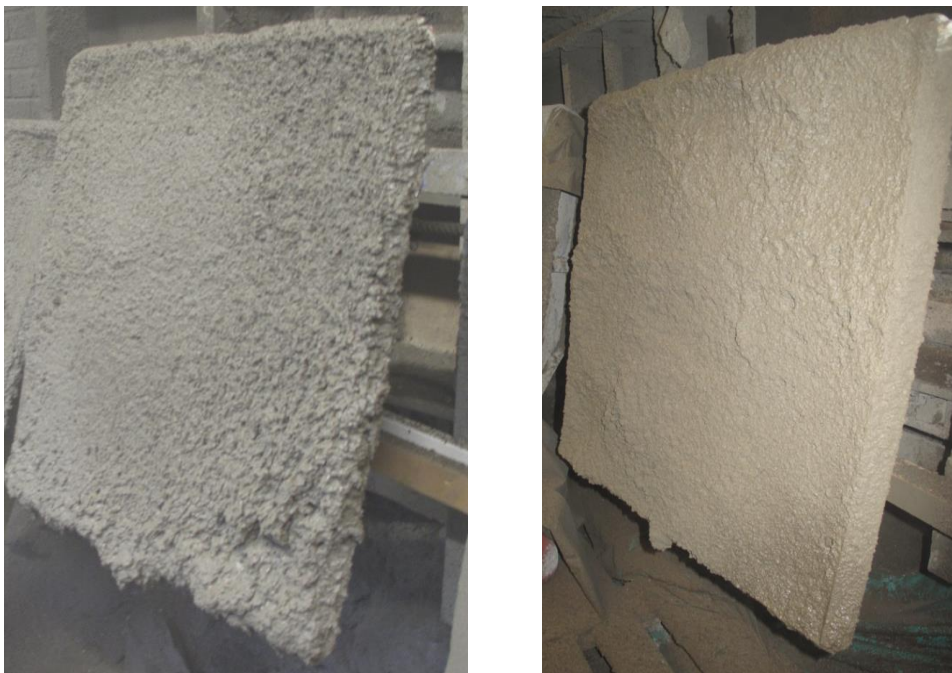
Figur 2: De sprutade provplattorna, utan hydrofoberingsmedel till vänster och med hydrofoberingsmedel till höger.
