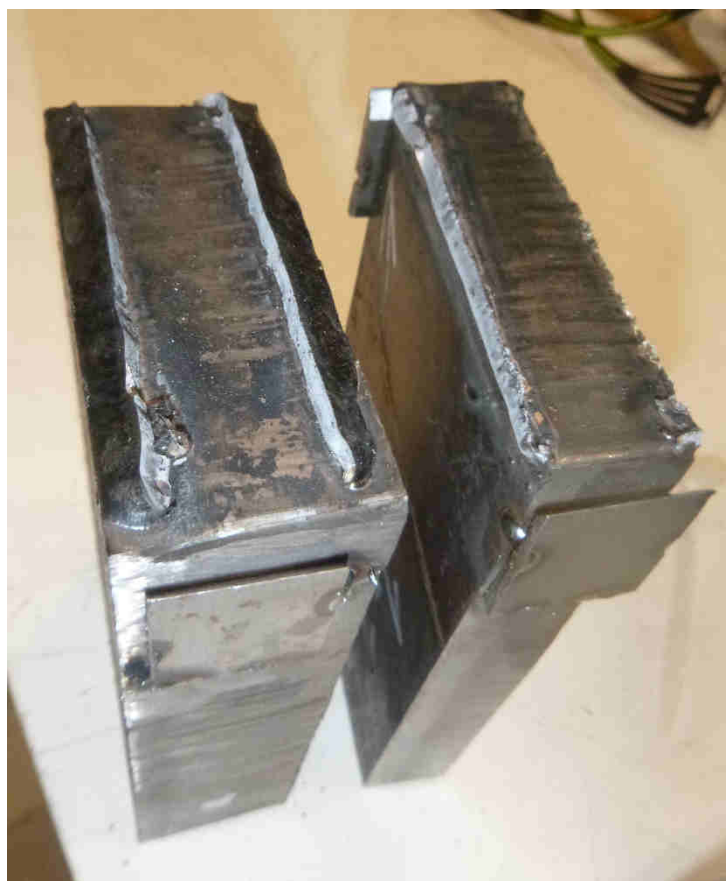
Figur 3-4 Exempel på brottytor och beteckningar
