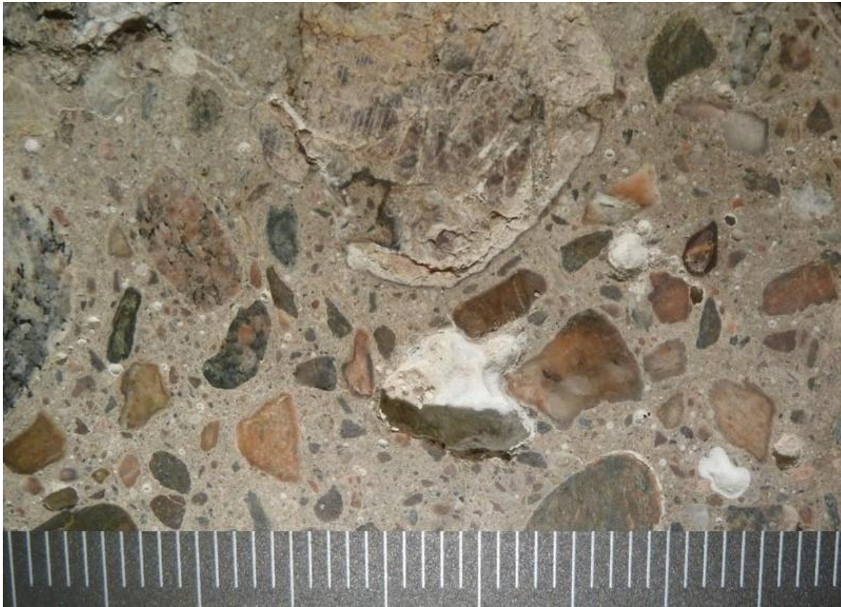
Figur 5. Slipad betongyta, lämplig att användas för DRI. I bilden kan man se sprickor i ballast och cementpasta fyllda med vit alkalisilikagel.
