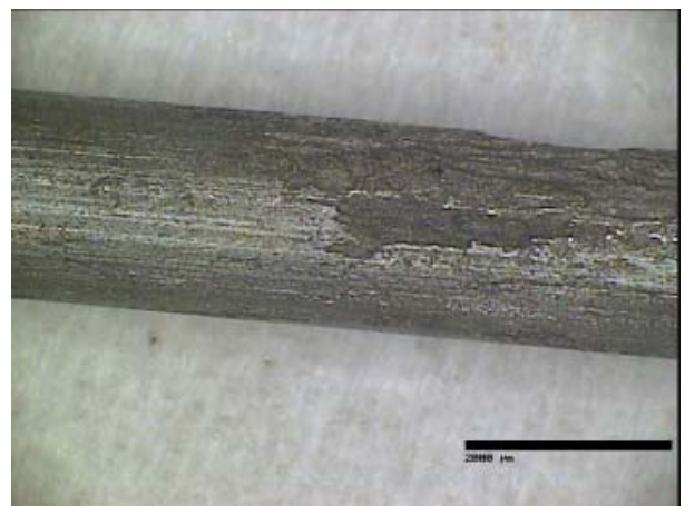
Bild 12. Tråd 34, korrosionshastighet 36 µm/år
