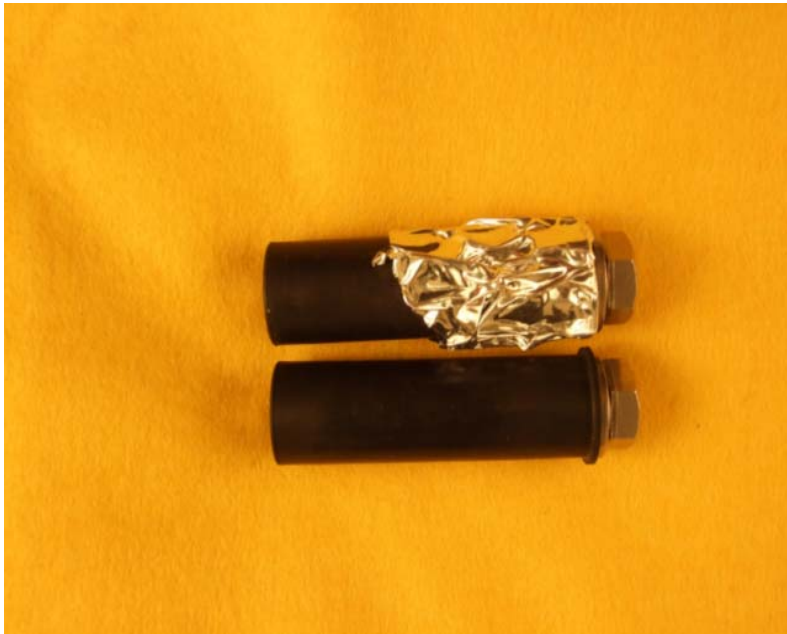
Bild 1. Expanderbultar av gummi för förslutning av borrhål
