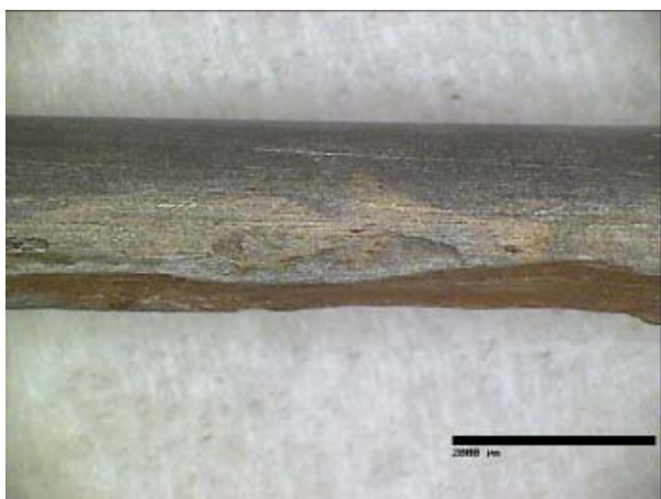
Bild 13. Tråd 39, korrosionshastighet 65 µm/år
