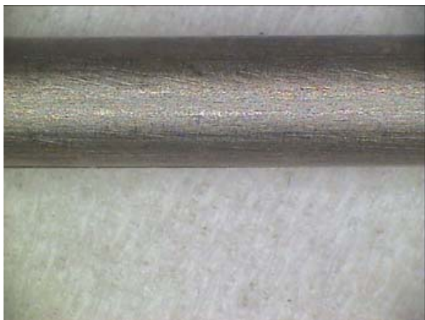
Bild 7. Tråd 17, korrosionshastighet 1 µm/år
