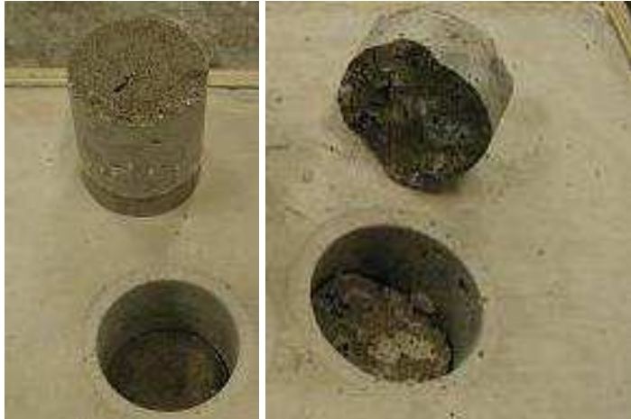
Figur 6 – Vid pågjutning på torrt underlag erhöles fogbrott (vänster) i de flesta fall. Undantaget var vid pågjutning med betong vct 0,55 där 3 av 9 brott skedde i pågjutningen och 2 av 9 i underlaget.
