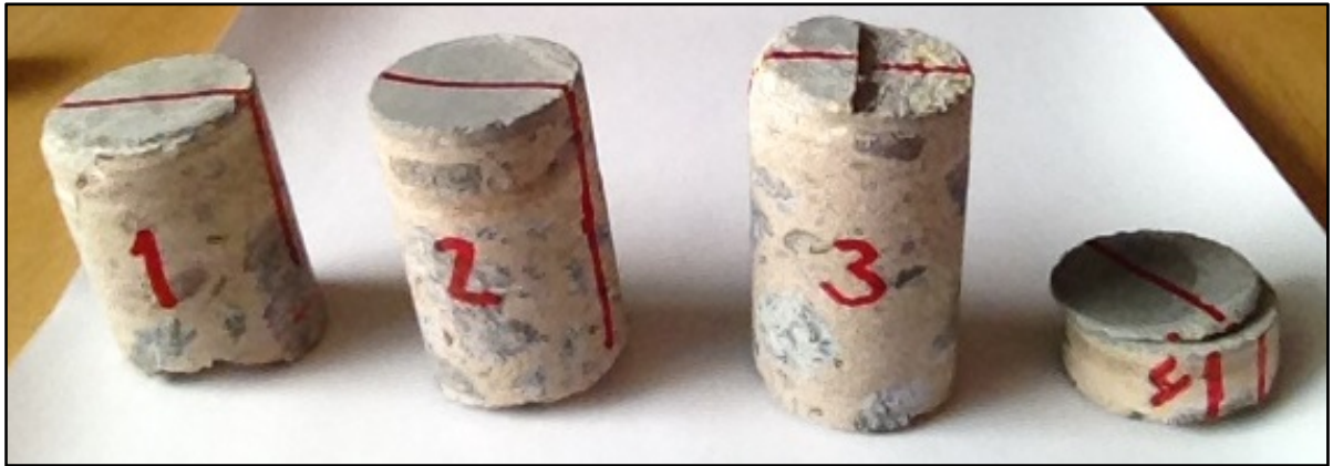
BILD 9. Fyra prover togs ut, av dessa tillverkades varsitt tunnslip. Tunnslipen tillverkades från ytan där de röda strecken på proverna är ritade.
