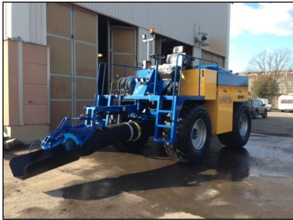
BILD 4. Betongdumper, Linotol AB.
