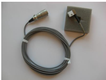
Figur 29. Accelerometer som användes på provkropparna.
