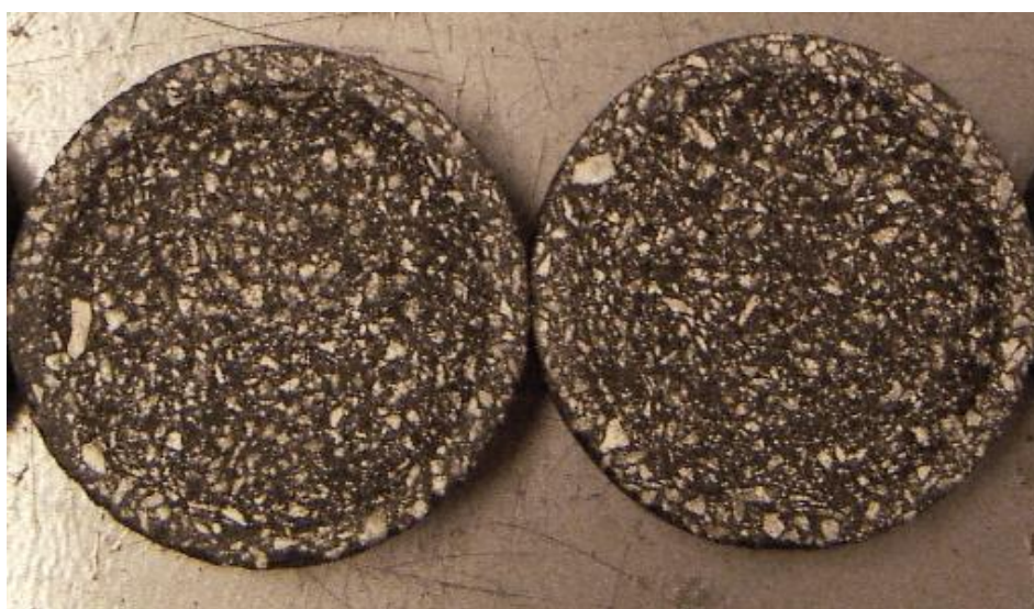
Figur 19. ABT 4 efter prallkörning
