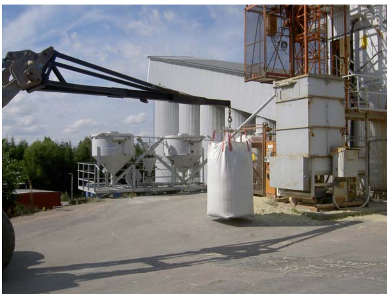
Bild 6 Leverans av fiber till asfaltverket. Fibern hålls över i behållaren till höger.
