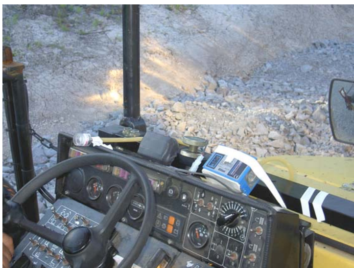
Bild 5 Mätutrustning monterad på förarplatsen.
