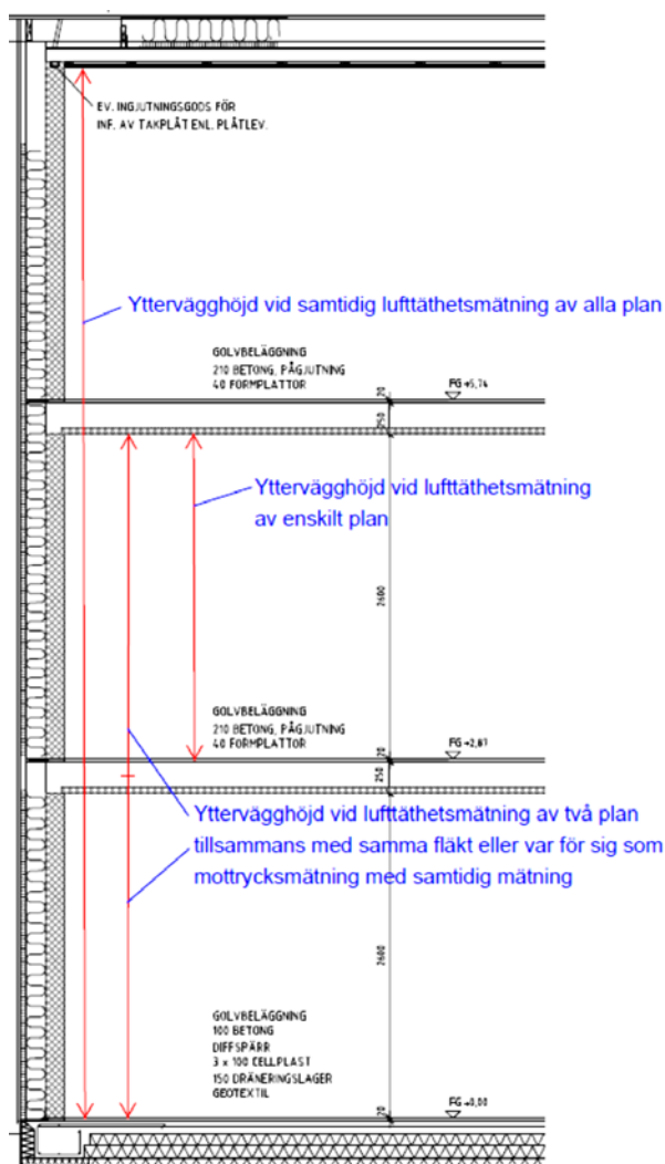
Figur 6.4. Ytterväggshöjd som får medräknas till omslutningsarea vid lufttätetsmätning av ett respektive flera plan. Figuren är ett vertikalsnitt men principen gäller även horizontalsnitt vid provning av lägenheter.
