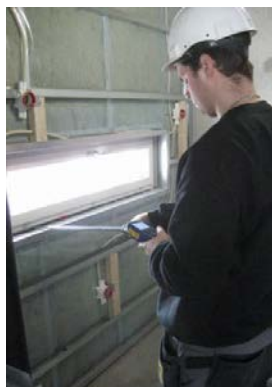
Läckagesökning med värmekamera, lufthastighetsmätare och rökgas.
