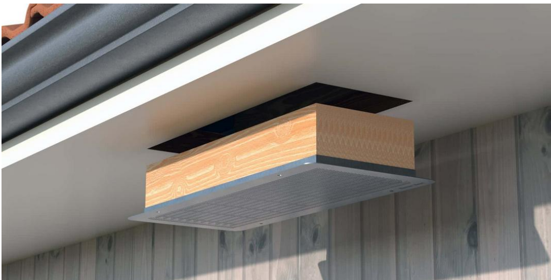
Figur 6 Exempel på takfotsventil som klarar EI 30 och anges klara glödbbrandspridning. Ventilen ej placerad i sitt slutliga läge. Bild: Eld&Vatten
