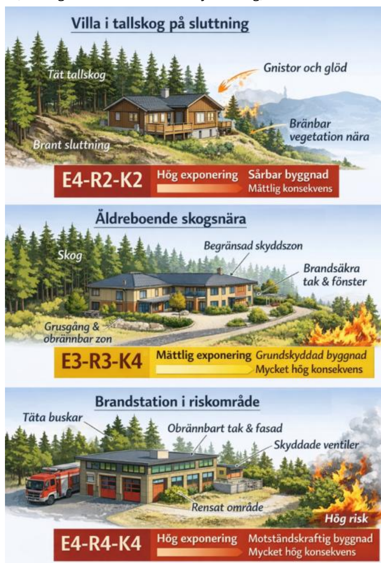
Figur 15 Exempel på olika byggnader med olika exponering, robusthet och konsekvens. Bild: Brandskyddslaget AB
