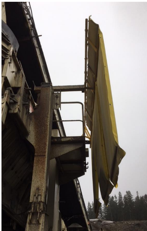
Figur 2: Gummimattor som avskärkning åt ett specifikt väderstreck kan monteras likt denna applikation för att minska buller mot exempelvis bebyggelse.
