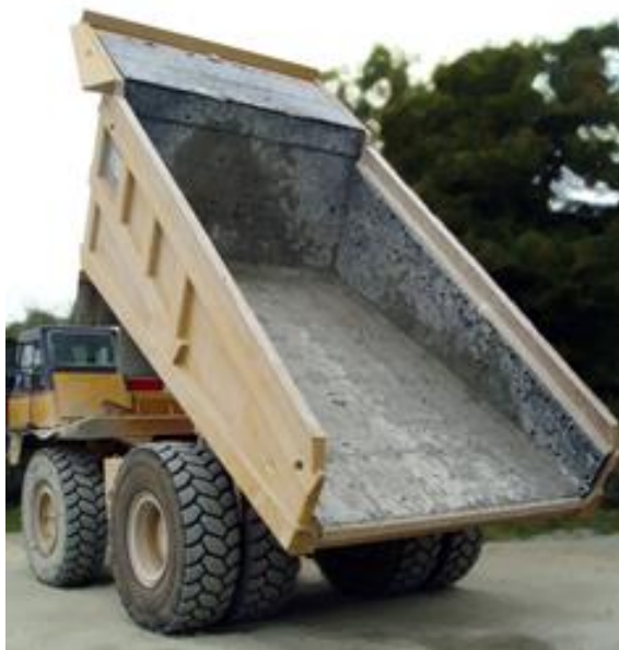
Figur 3: Gummiklädda fordonsflak minskar bullret avsevärt. Inte bara vid lastning utan även vid avtippning uppstår mycket buller. Minskning ca 10-15db, kostnad 100'-200' sek.
