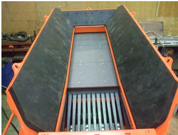
Figur 4: I stupet eller i mataren vid inlastningen faller gumminklädnad att oljud och buller inte fortplantar sig i metallstativen. Minskning ca 10-15db, kostnad ca 40' sek.
