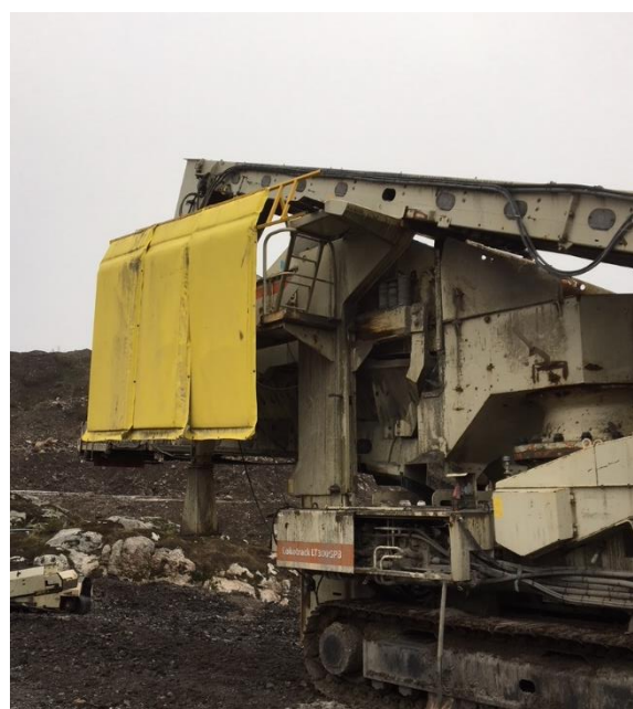
Figur 2: Gummimattor som avskärkning åt ett specifikt väderstreck kan monteras likt denna applikation för att minska buller mot exempelvis bebyggelse.
