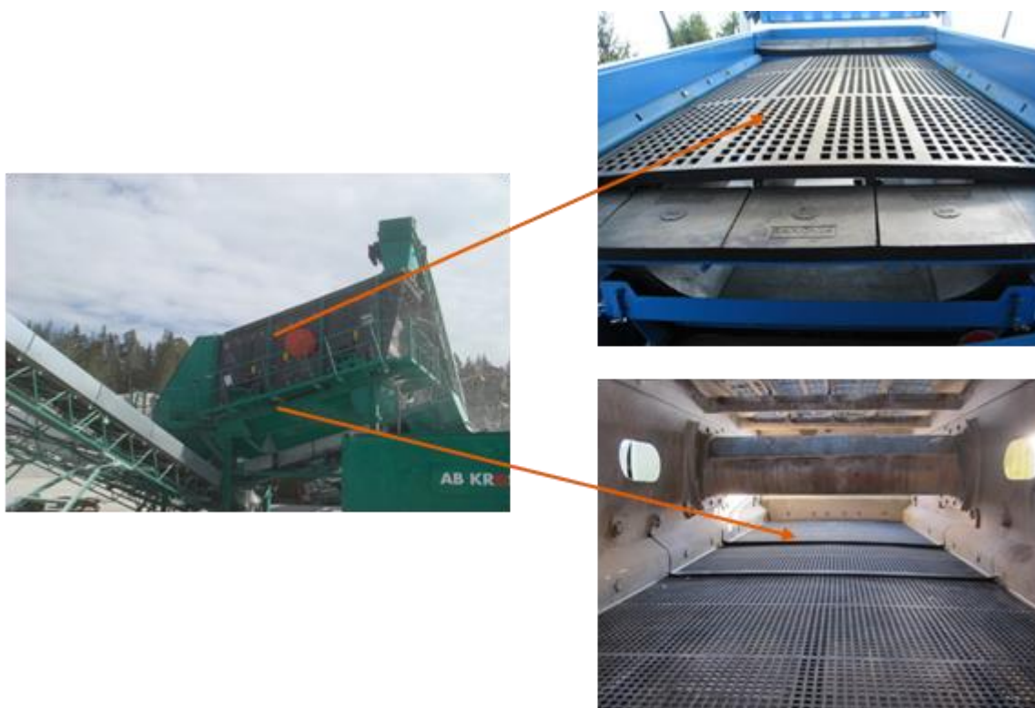
Figur 5: Byte av siktmedia från trådsäll i stål till ett polymert siktmedia minskar bullernivån kraftigt. Bl.a Sandvik kan erbjuda polymert siktmedia med samma öppenarea som trådsäll. Minskning 10-15db. Kostnad 25'-75' sek. Polymer siktduk håller upp 10x en trådduk vilket gör att kostnaden per ton krossat material ofta kan räknas hem.
