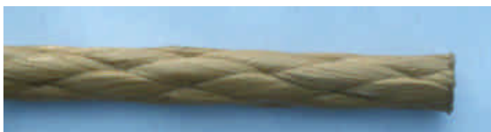
Figur 7.5 Flätad japansk FiBRA armeringsstång. (Foto: R. Tepfers).
