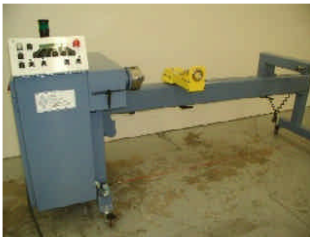
Figur 7.9. Lindning av cylindriskt fiberkompositrör. (Saint-Gobain, Vertrote).
