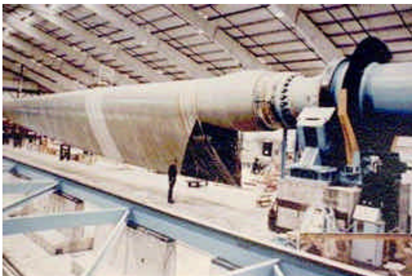
Figur 7.11. Turbinvinge till vindkraftverk tillverkas med bland annat fiberlindning, (Entec Composite Machines, Inc a Zoltec Company).
