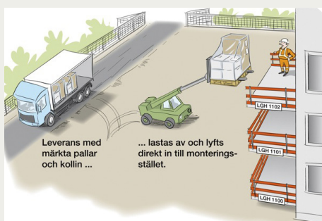
Figur 3. Ett av målen med standarden är att kunna lossa godset direkt från en lastbil till den korrekta positionen för montering.
