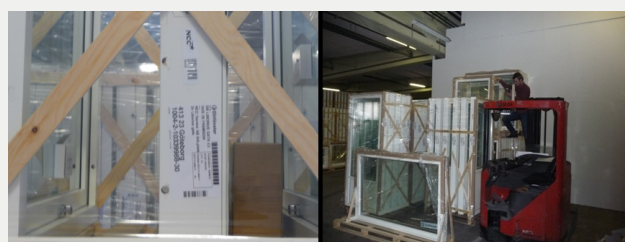
"Taggning" med RFID-etiketter på fönster hos leverantören Eliifönster innan avfärd mot NCC:s arbetsplats. Personal på plats läser av etiketterna, kontrollerar paketen och anger "klart för leverans".
