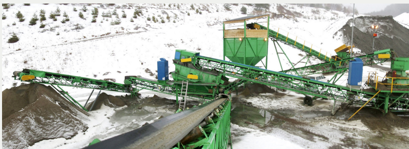
Figur 3. Jehanders krossanläggning för halkstopp i Fjärås där försöken med algoritm för val av spalt utfördes.
