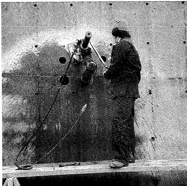
Fig. 2 Utborrning av provcylindrar
