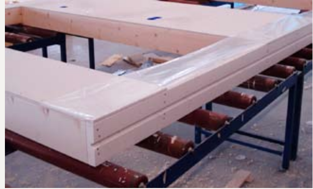
Bild av syll med spår.
