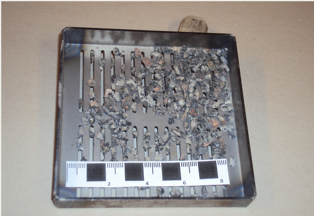
Bild 1. Manuell siktning av finballast på spaltsikt.
