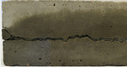
Figur 2. Betongytan efter fyra repetitioner av urlakning, frysprovning och nötning (vänster bild). Spräckt provkropp till följd av makroskopisk islinnsbildning (höger bild). Islinnen är jämntjock över tvärsnittet.
