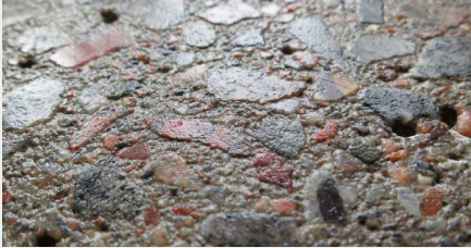
Figur 2. Betongytan efter fyra repetitioner av urlakning, frysprovning och nötning (vänster bild). Spräckt provkropp till följd av makroskopisk islinnsbildning (höger bild). Islinnen är jämntjock över tvärsnittet.
