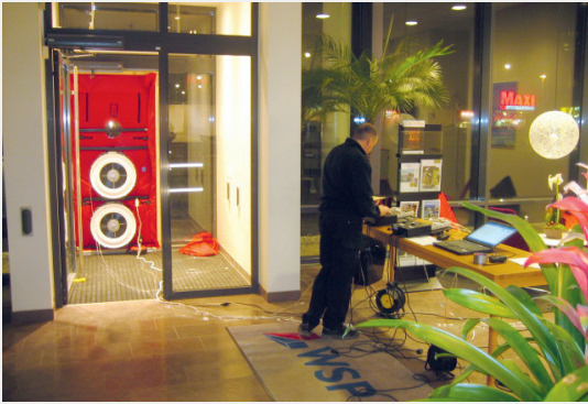
Blower doors monterade istället för entrédörren.
