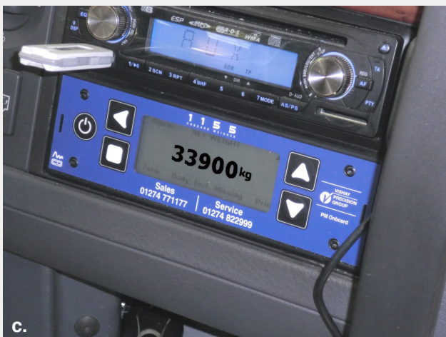
Trailerbilen lastas först framtill (a.), därefter baktill till full last, vilket kontrolleras med handburen display (b.) och registreras i centralenheten i förarhytten (c.) Värdena bekräftas sedan med vägning på en krönt utlastningsvåg (d.).
