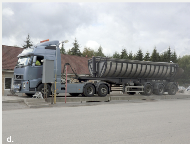
Trailerbilen lastas först framtill (a.), därefter baktill till full last, vilket kontrolleras med handburen display (b.) och registreras i centralenheten i förarhytten (c.) Värdena bekräftas sedan med vägning på en krönt utlastningsvåg (d.).
