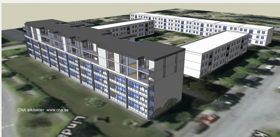
Miljonprogramshus med prefabricerad tilläggsisolering av fasaderna och prefabricerad påbyggnad i två våningar (CNA arkitekter).
