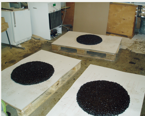
Bild 3. Tiden för gjutasfalten till att flyta ut till bestämda diametrar mäts och ett flytmått erhålls.
