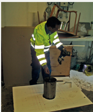
Bild 2. Kon för prov med Flytcylindermetoden. Här kollas temperaturen på den ifyllda gjutasfalten.
