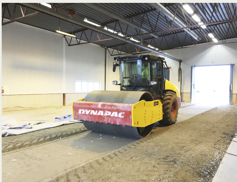
Figur 1. Packningsförsök med vibrerande enkelvalsält.
