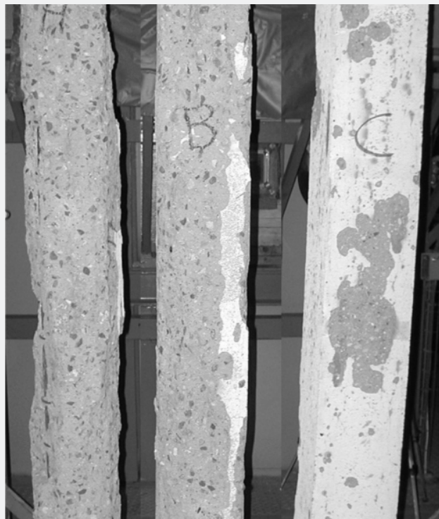
Bilden visar pelare som varit utsatta för ett standardiserat brandförlopp enligt HC-kurva. Betongen i pelarna har vattencementtalet 0.40, tillsatt mängd plastfibrer är (från vänster till höger) 0, 2 och 4kg/m 3 . Foto: SP
