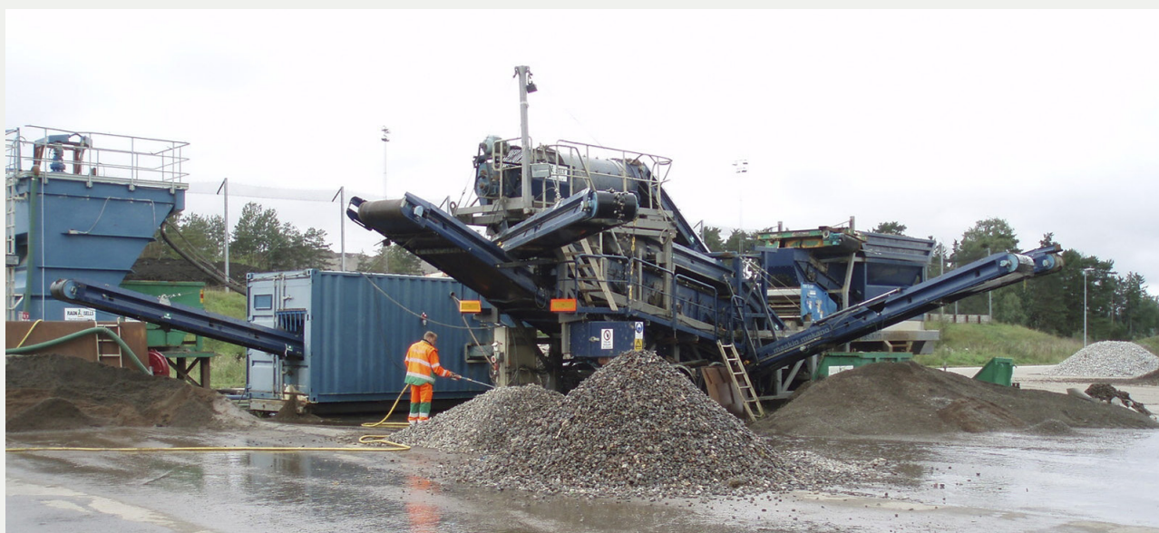
I en kompakt och avancerad anläggning tvättas materialet rent från slam och ämnen och delas samtidigt upp i olika fraktioner.
