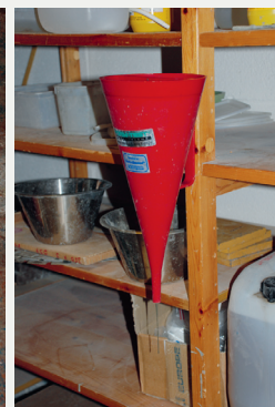
Figur 1. Finbrukstester för allt material upp till kornstorleken 0.25 mm. a) minisättkonen; b) finbrukets utbredning på fuktad glasskiva, c) tömning av finbruket genom Marsh-tratt med 10 mm öppningsdiameter i munstycket.
