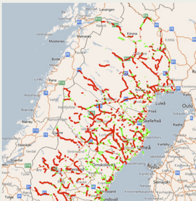
Figur 1. Vägar med (översta) beläggningsslag av mjukbitumenbundet grus (mjog) i rött, ca 8 070 km, oljegrus i grönt ca 2 700 km (PMSV3, 2013).
